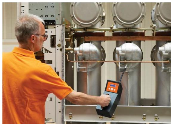
O SF<sub>6</sub> LeakSpy permite a detecção e quantificação de concentrações mínimas de SF<sub>6</sub> (precisão: 1 ppm<sub>v</sub>)
